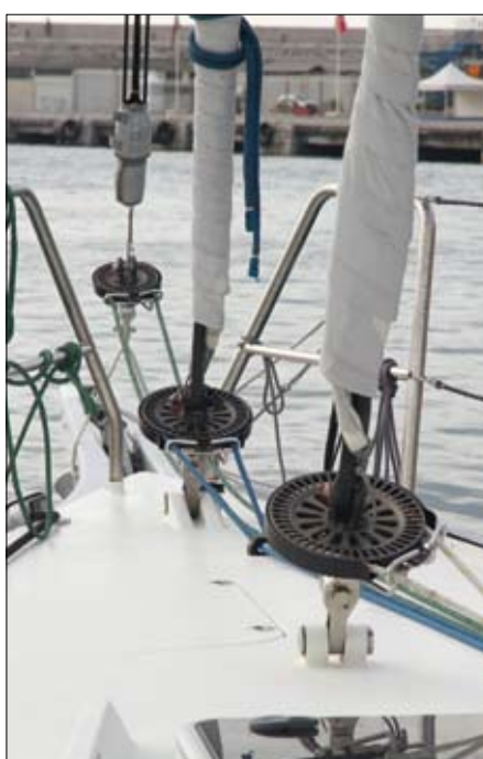
▲ Toutes les voiles d'avant sont sur stockeur pour avoir toujours la toile du temps.
