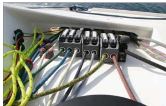
▲ Le piano n'est pas sur le rouf mais à tribord sur le pont, juste devant le winch électrique.
