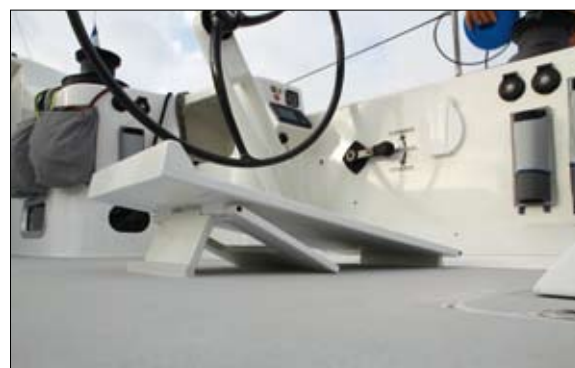
▲ Trois positions possibles pour le cale-pieds du barreur pour être toujours bien installé à la barre.
