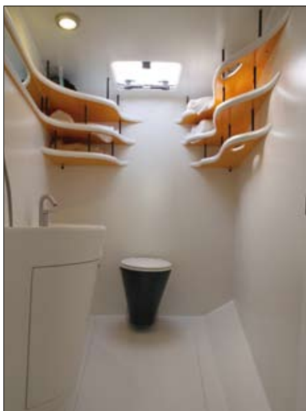
▲ Les fameuses toilettes centrales du JP54 avec la cuvette des WC montée sur cardan.
