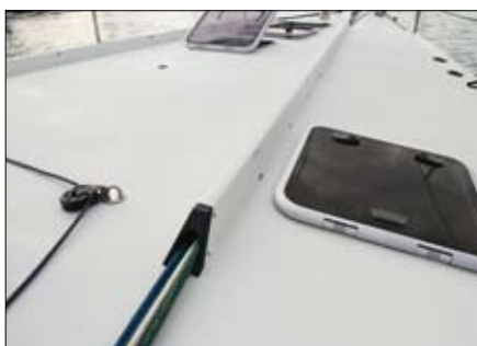
▲ Les commandes d'enrouleur des voiles d'avant circulent à l'intérieur d'un cale-pieds.
