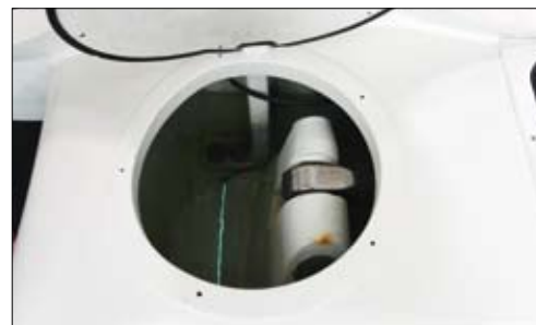
▲ La tête de quille est facilement accessible. A l'arrêt, le voile de quille est légèrement incliné sur bâbord.
