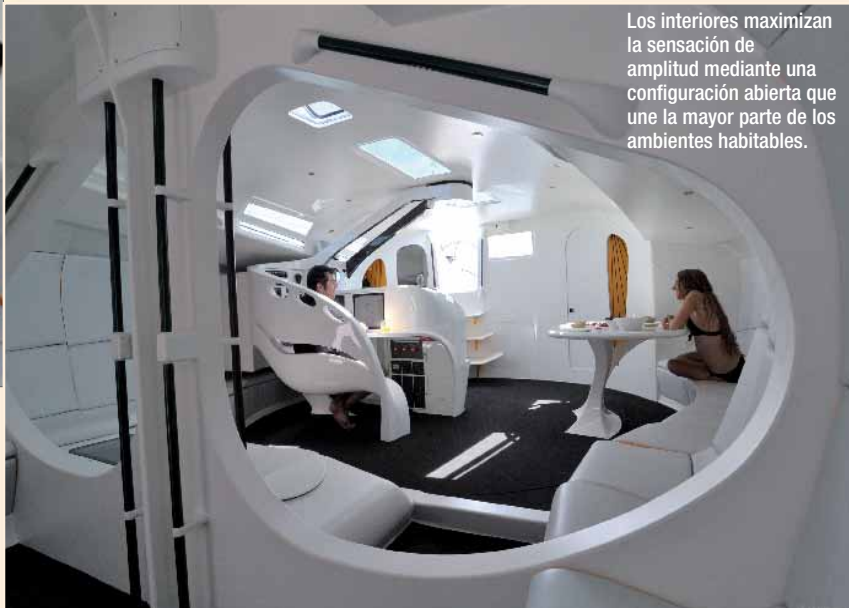
La mesa de cartas y su asiento quedan integrados en su totalidad en un generoso módulo que rota para poder desplazar el peso a barlovento y reducir así la escora durante la navegación.
